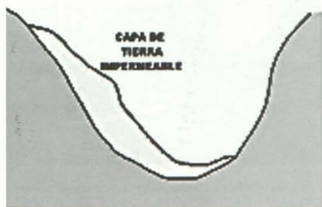
Figura 1.- Apertura de la zanja y colocación de la tierra impermeable
