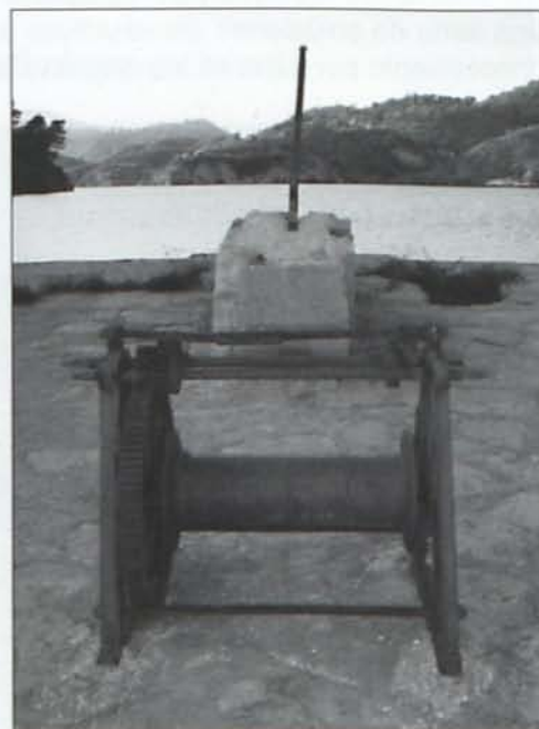
A la izquierda, vista del cuerpo de la presa de Tibi (1596). A la derecha detalle del sistema pescante con torno que se empleaba para la subida y bajada de una barrena de 18 m. de longitud y 500 kg. de peso utilizada en las "limpias naturales" del Pantano de Tibi 6 . Fotos del autor.
