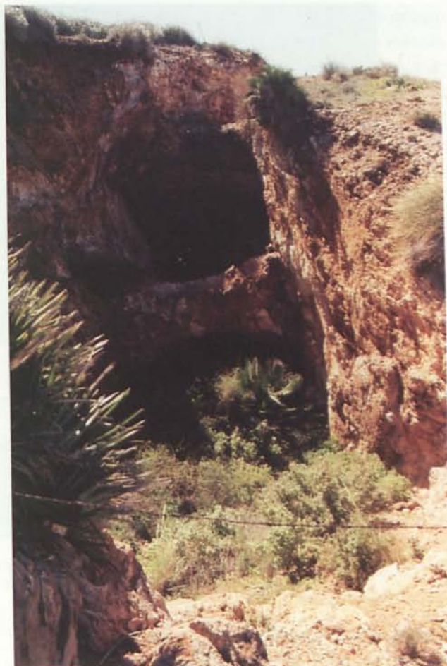
Foto 4. El filón principal de «María Josefa» se explotó hasta la calle. (Foto G. Leal)
