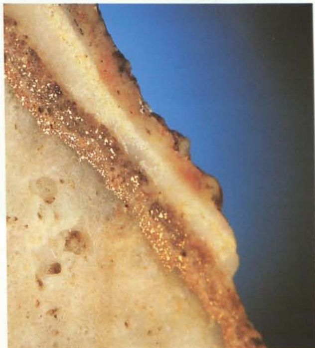
Foto 8 (arriba). Cuarzo oqueroso («vuggy silica») resultado de la silicificación de la dacita del Cinto. De la textura original sólo quedan cristales de cuarzo libre de la roca. Los huecos son moldes de cristales que han sido alterados y lixiviados (10 x 7 cms). (Foto G. Leal)
