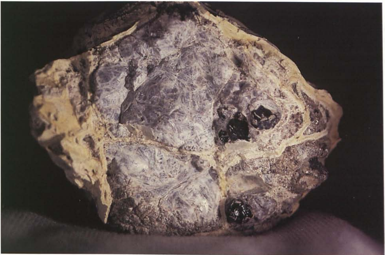
FOTO 7: Detalle de la perlita-obsidiana del yacimiento nº 2. Negro obsidiana, gris perlita, y blanco amarillento material intersticial constituido por arcilla montmorillonita producto del proceso de desvitrificación de la perlita. Dimensión mayor, 15 cm.
