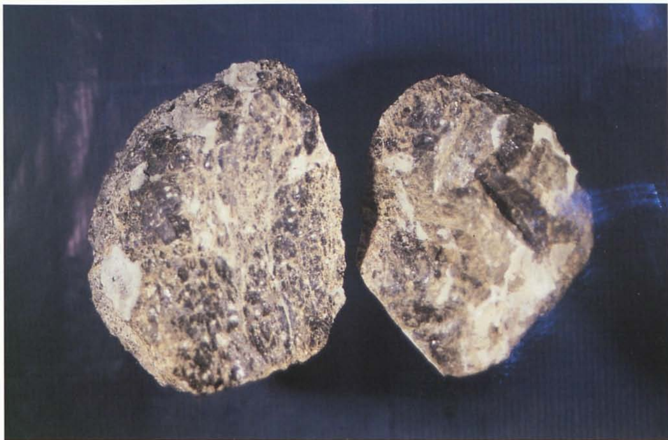
Foto 17: Dos muestras de pitchstone de 10 cms. de mayor dimensión. Se aprecian restos de nódulos de vidrio sin hidratar (obsidianas) e incluso de posible perlita (primer grado de hidratación)
