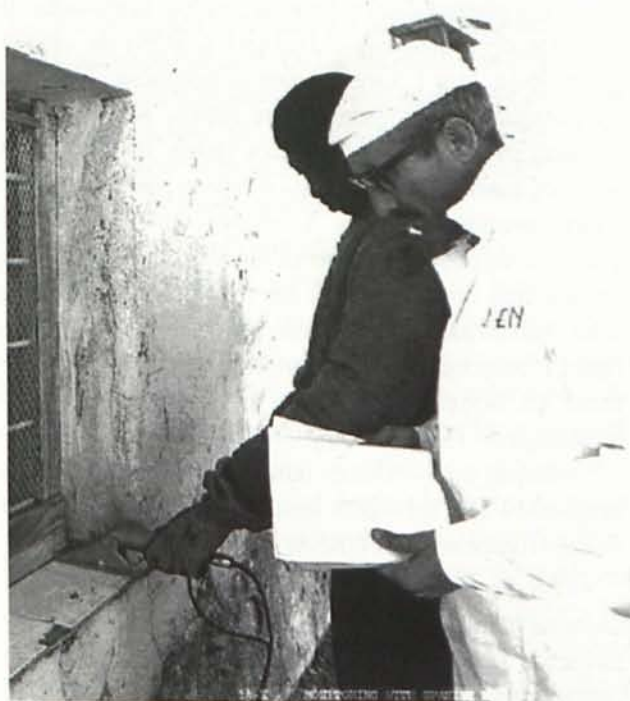
3. Un miembro de la Junta de Energía Nuclear (JEN) coteja con un soldado norteamericano datos de lectura en un contador de radiaciones alfa «PAC 1S», para evitar diferencias en el levantamiento de un mapa radiométrico de la zona. (Cortesía Pitaco Producciones)
