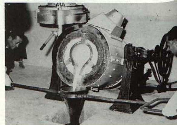
Figura 24. Proceso de fundición de un lingote de oro (Fernández Espinar, 1958).
