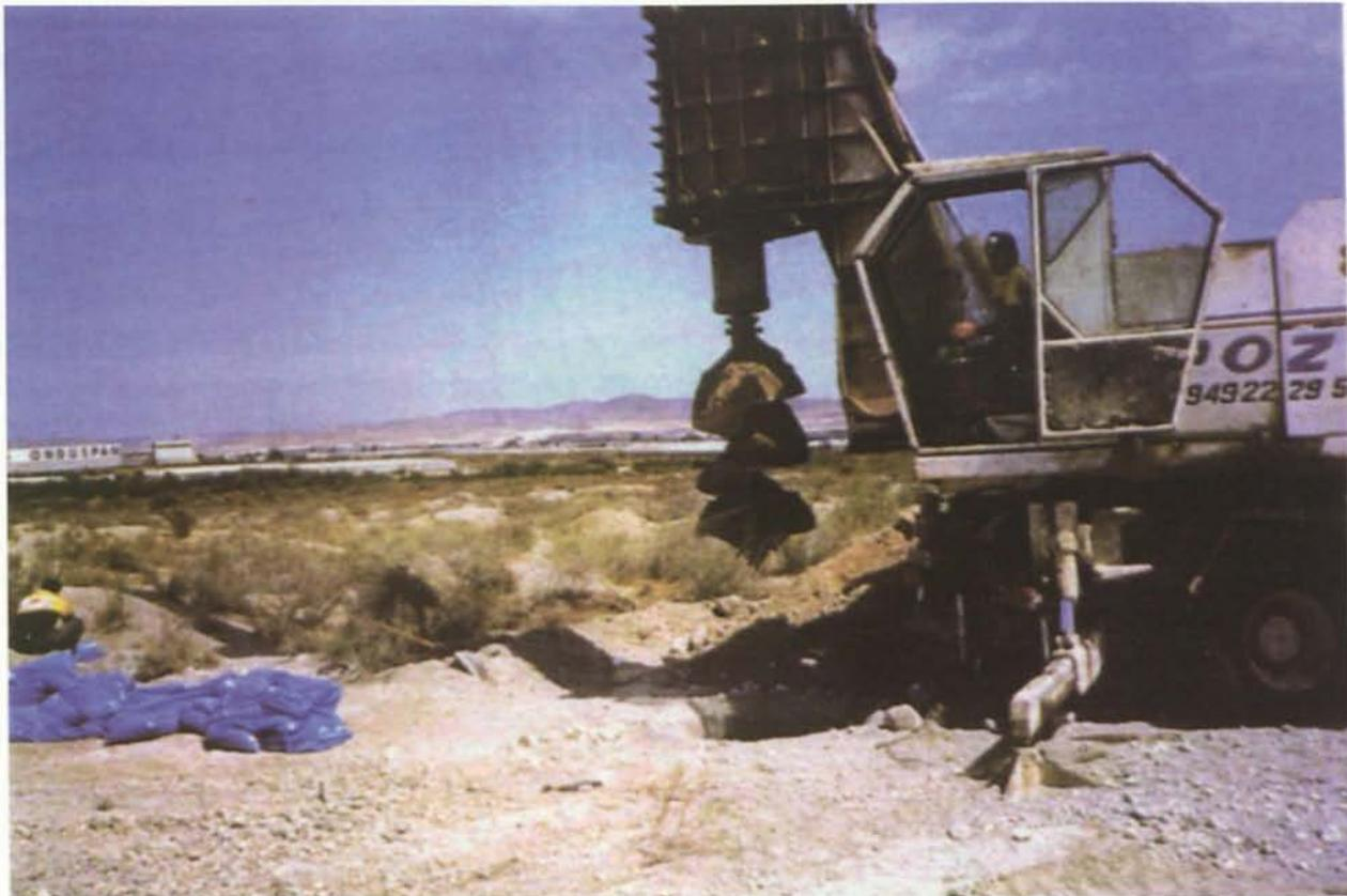
Foto 22. Camión con helicoide de demuebre utilizado para estudios geotécnicos y en este caso para evaluar el yacimiento ya que el coluvión granatífero no pasa de 5 metros de profundidad. (Gentileza de J. M. Fidalgo)
