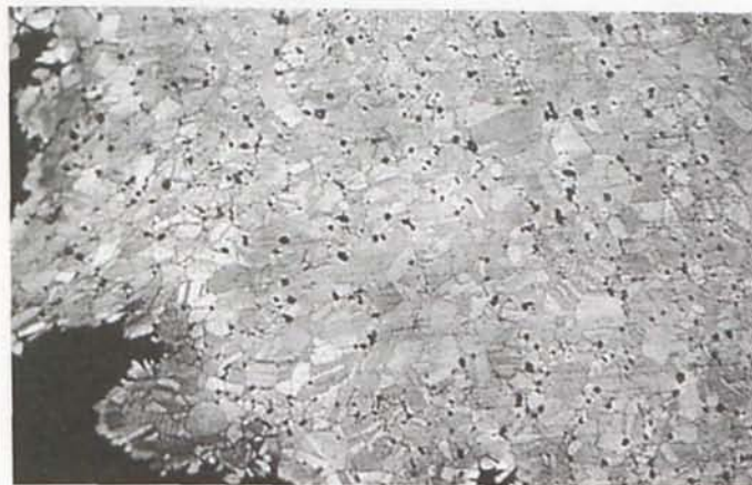
LÁM. III. Metalografía del fragmento de vasija horno B7-235 (200x).
