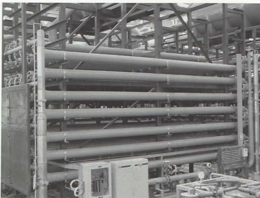
7. Bastidores de membranas. 10.000 m 3 /día. (Col. del autor)
